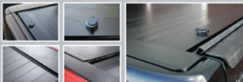
Рулоновая КРЫШКА Плато изготовлена из невероятно мощных стальных плиток, которые в открытом положении катятся во внутрь передней части автомобильного плато (как оконная штора).
