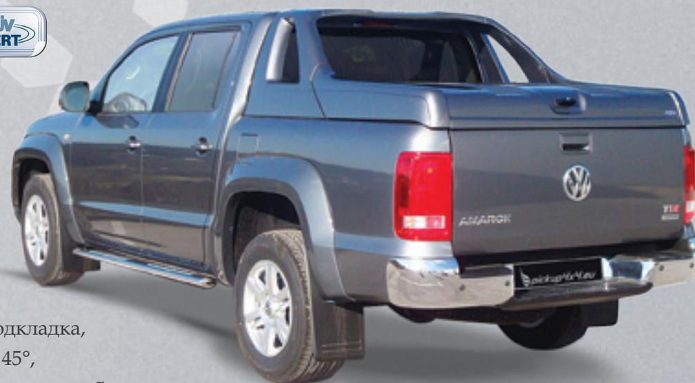
Это вариант покрытия плато автомобиля предостерегает его пикап характер и дает автомобилю динамический внешний вид. Крышка изготовлена из стекловолокна, открывается под 45° и закрыта на ключь.
